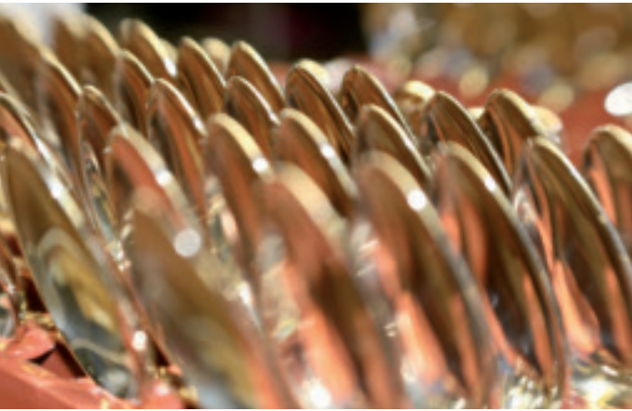
Die Laffen – die Vorderteile der Löffel – stehen bereit für die Weiterverarbeitung. In den Ateliers von Wilkens wird graviert und geprägt.
