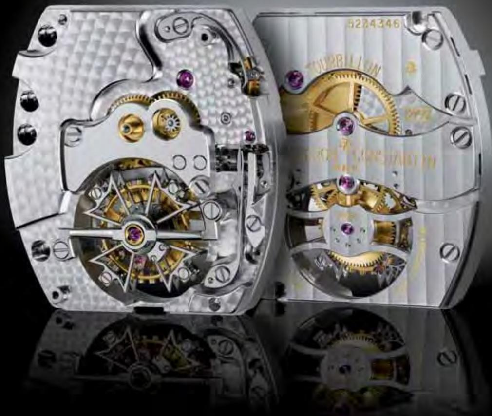
Das Tourbillonkaliber «2795» der «Malte Tourbillon» mit Handaufzug besteht aus 246 Einzelteilen und arbeitet im Takt von 2,5 Hertz (18.000 Ampere pro Stunde) nach Vollaufzug fast zwei Tage lang.
