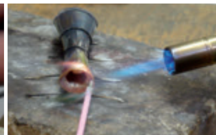
Die Laffe einer Kaviarschaufel aus Gold 750 wird gefeilt (links). Die Halbschalen vom Messergriff des Modells «Bremer Lilie» werden mit Silberdraht verbunden und dann zusammengelötet (rechts).
