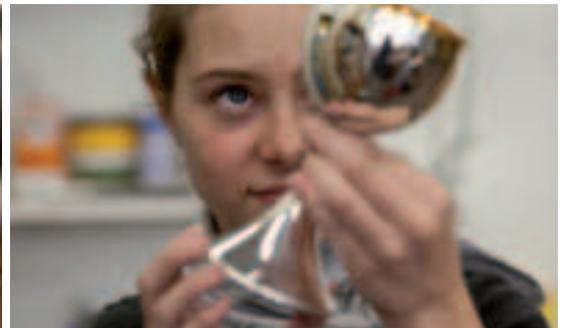
ist eine uralte Technik. Schon bei den Römern wurde sie für die Herstellung von Gefässen und Schalen angewendet. Auf ähnliche Weise entstehen die Kelchfüsse. Es sind also zwei mal acht Teile, die trotz der Handarbeit perfekt und gleichmässig geschaffen werden müssen. Die Herstellung der edlen Winkelche ist ausserdem ein Kraftakt. Das Drücken heisst nicht umsonst so. Aber auch das Schleifen, Polieren und Hämmern erfordern neben der hohen Konzentration und dem Feingefühl Muskelkraft.
